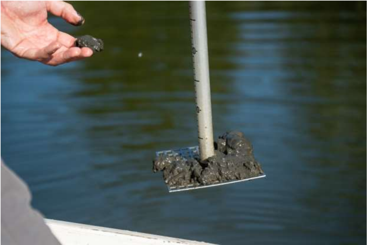
Figuur 3.1 Tijdens de milieu inventarisatie wordt onder andere de dikte van de baggerlaag gemeten vanuit de boot.
